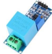
Gambar 5. Tampilan sensor tegangan ZMPT101B[15]
